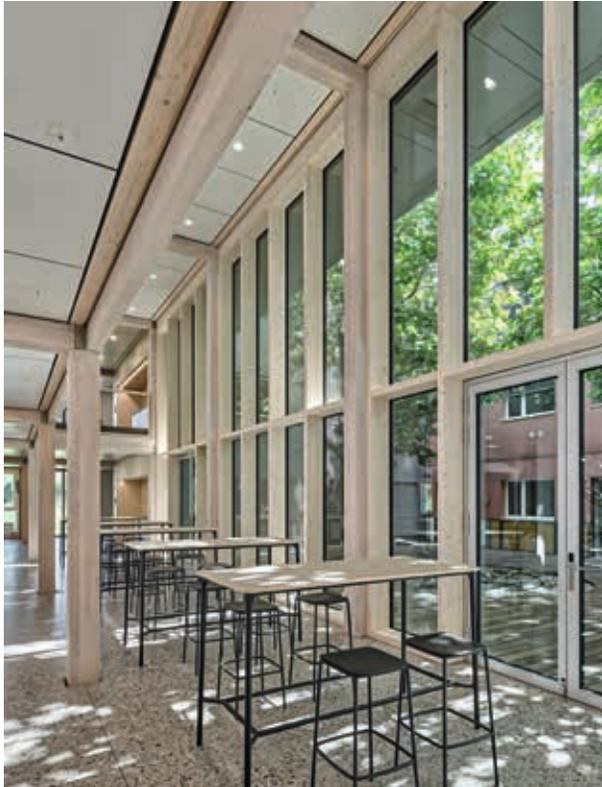
Die Atmosphäre des Erdgeschosses ist geprägt von der Tragstruktur aus Stabbuche und der Sicht in den Innenhof.
