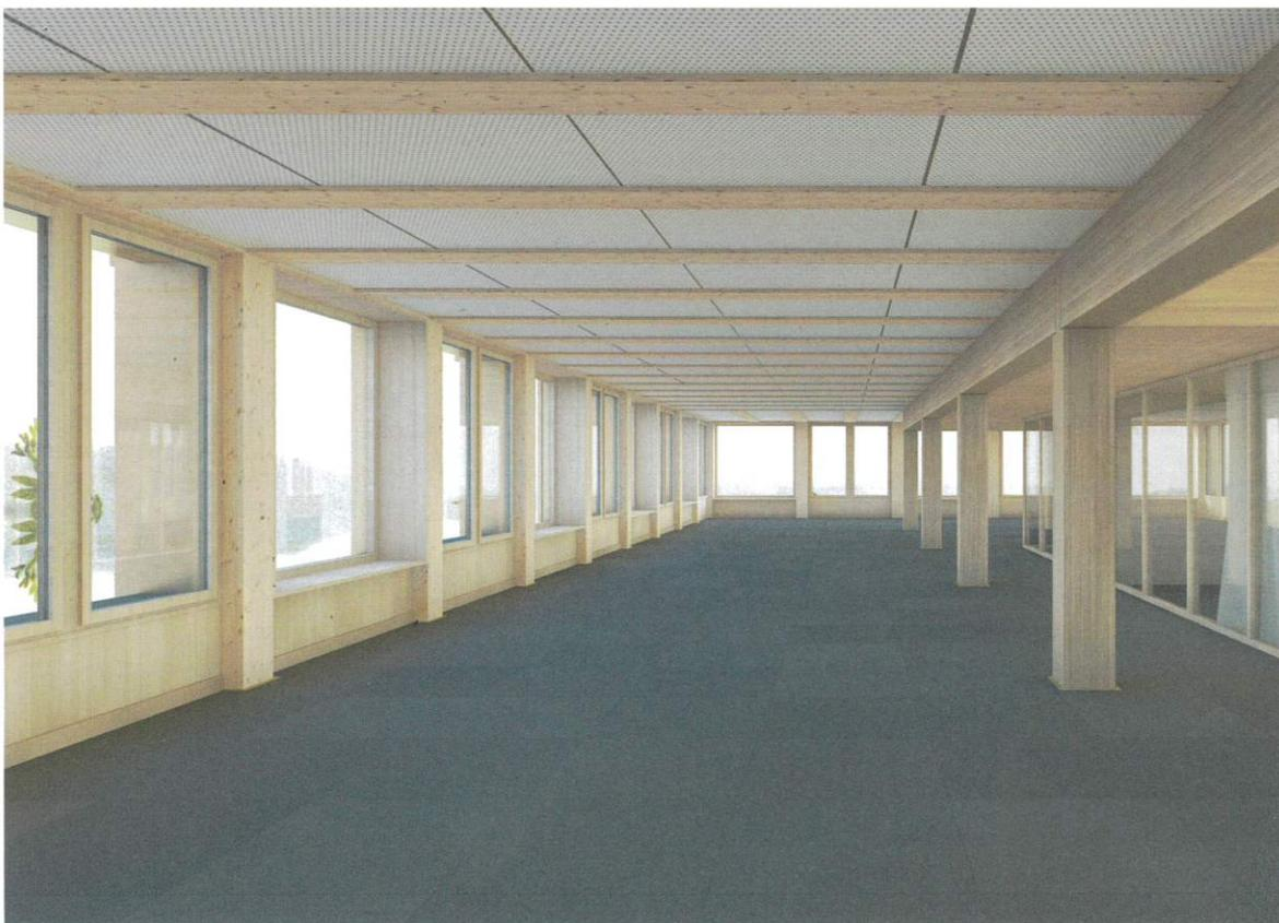
**Abbildung 73:** Dank einer Sprinkleranlage können die linear tragenden Bauteile im Innern sichtbar in Holz ausgeführt werden (Visualisierung: Burkard Meyer Architekten).
