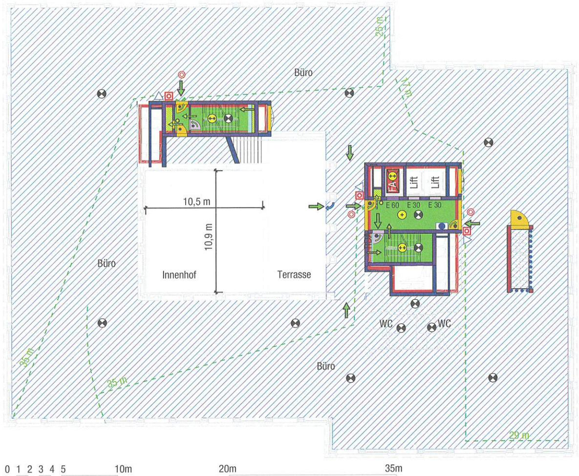
**Abbildung 76:** Im 1.–6. Obergeschoss sind die grosszügigen Büroflächen um die beiden zentralen Kerne angeordnet.
